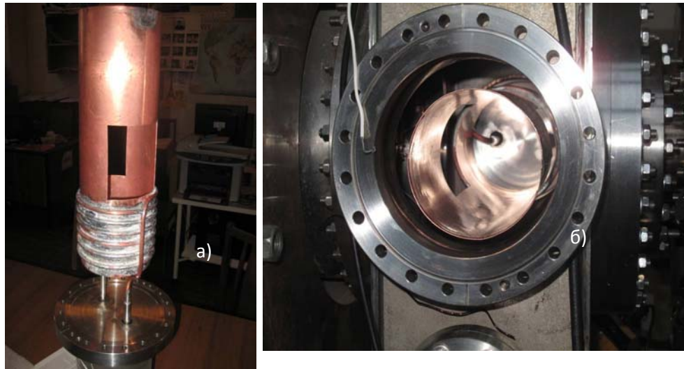
Рис.4.1. Криогенний екран: а) екран в зборі; б) встановлений всередині пастки.
